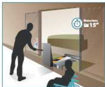
Une personne vient dépasser la rampe et il s'agit d'une rampe manuelle. La rampe peut aussi se déployer seule si elle est automatique.
