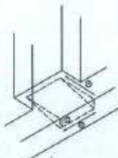
2) Enlèvement de gravats, lissage au ciment, présentation de la rampe (la rampe repliée doit être au même niveau que le seuil) et mise en place de 6 chevilles de fixation de la plaque support des marches rabattables.
