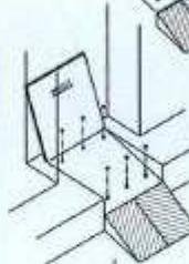
4) La marche est repliée. Collage au double face de la borne d'appel sur la vitrine, ou fixation par chevilles dans le mur. Le bouton poussoir doit se trouver à 1 m du sol du trottoir.
