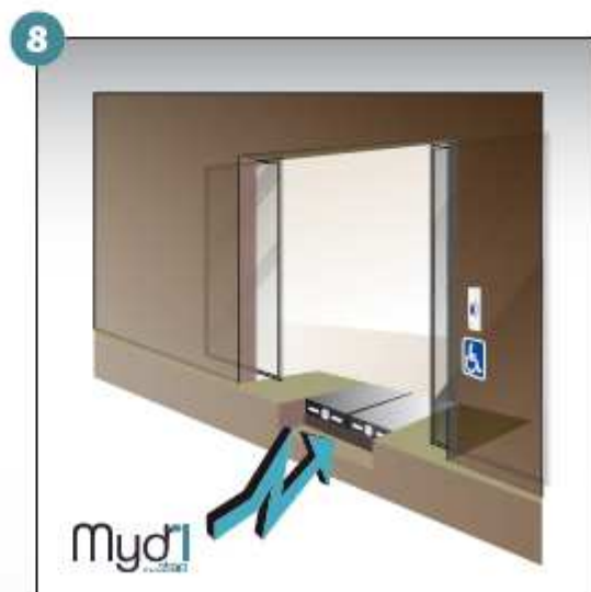
8 - Répéter les manoeuvres précédentes en sens inverse pour fermer la rampe
