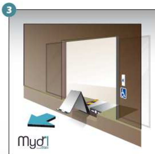
3 - Tirer le volet vers l'avant des deux mains.
