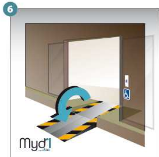
6 - Répéter les opérations pour la deuxième rampe.
