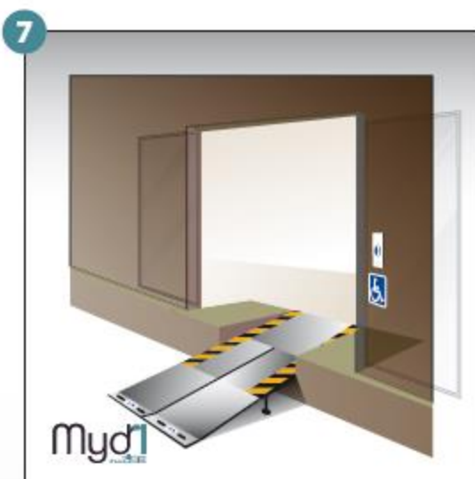
7- Rampe en service
