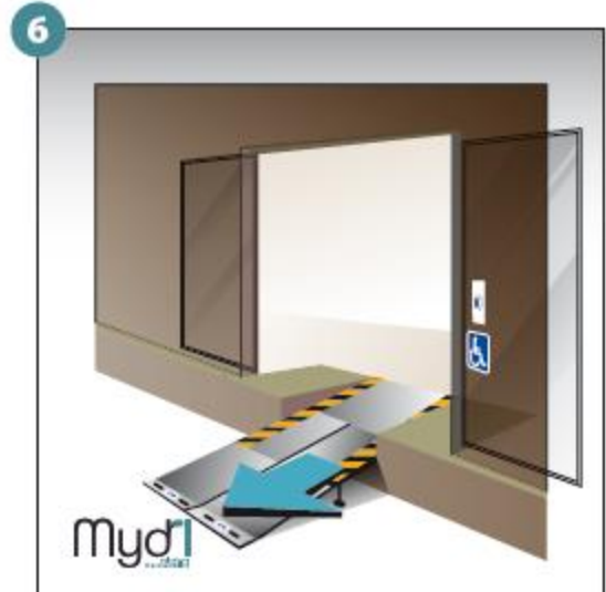
6 - Répéter les opérations pour le deuxième volet
